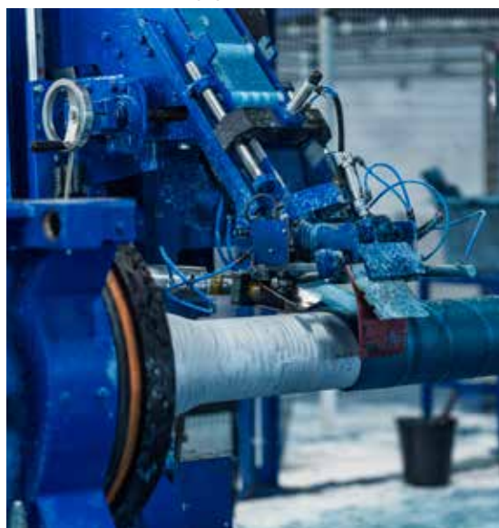
ZMU-Austria (rivestimento di malta cementizia)
