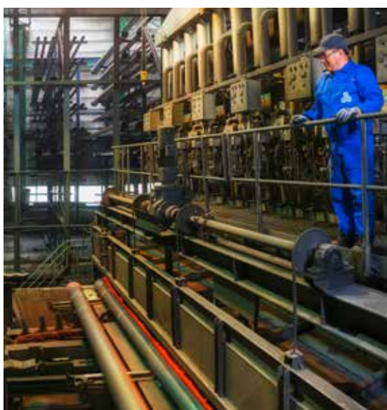
Forno di ricottura per migliorare le proprietà del materiale
