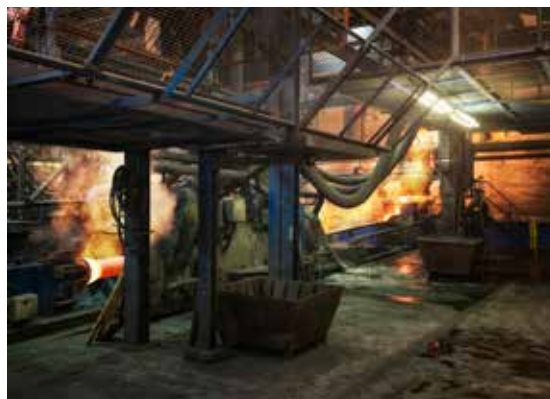
Macchina a colata centrifuga
