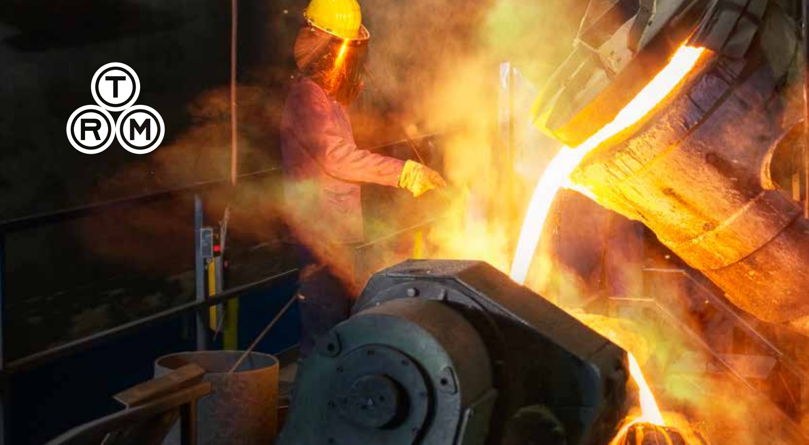
Riempimento della macchina a colata centrifuga
