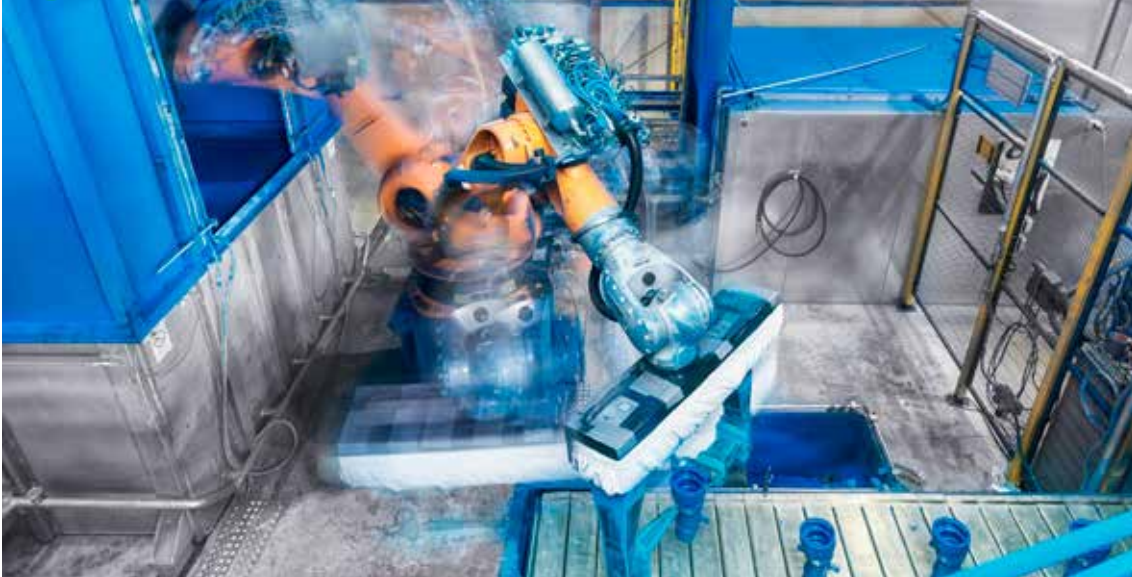
Impianto robotizzato per rivestimenti presso lo stabilimento di Hall in Tirol in azione
