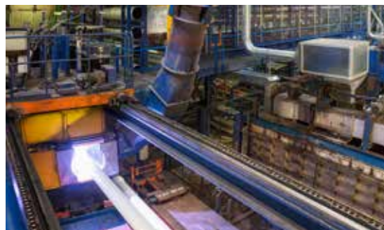
Zincatura a caldo applicata a spruzzo
