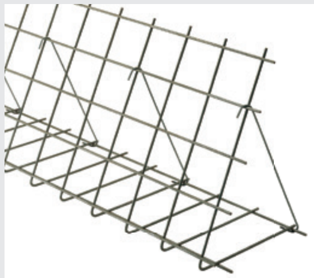
Il cassero viene fornito corredato di tiranti di irrigidimento (1 ogni 0,45 m circa).
