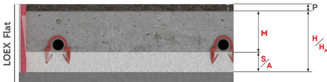
P - Spessore del rivestimento del pavimento
